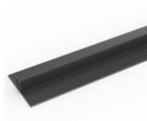
Perfil de unión de dos piezas que se pueden soldar para unir rollos de extremo a extremo o de lado a lado para cubrir áreas más grandes. Se recomienda un tubo de pasta para la soldadura en frío por cada 10m de borde. Disponible en gris oscuro. Tamaño: 10.5mm x 2.5m
