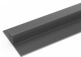
Riel a presión de dos partes que se puede soldar para unir rollos por los extremos o los lados para cubrir grandes áreas. Recomendamos un tubo de pasta de soldadura en frío por cada 10 m de bordes. Disponible en gris oscuro. Tamaño: 10,5 mm x 2,5 m (13/32" x 8'2")
