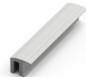
Necesitarás esto para asegurar la alfombra por los bordes de izquierda a derecha. Se suministra en secciones de 3 m (10') de largo con tornillos y tacos de fijación. Disponible en aluminio anodizado, gris oscuro con pintura en polvo y negro. Tamaño: 10 mm x 12 mm (3/8" x 15/32")
