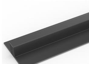
Rail d'accrochage en deux parties qui peut être soudé ensemble pour joindre les rouleaux de bout en bout ou d'un côté à l'autre pour couvrir de grandes surfaces. Nous recommandons un tube de pâte à souder à froid pour 10 m de profilé. Livré en noir et gris foncé. Taille: 14 mm x 2,5 m
