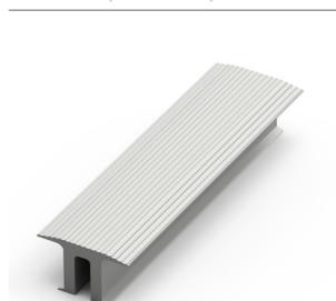
Vous pouvez utiliser un Profilé en T (27 mm) pour diviser le tapis en sections de gauche à droite, ce qui facilite le levage et le nettoyage. Fourni en sections de 3 m de longueur avec vis de fixation et chevilles. Existe en aluminium anodisé, gris foncé ou noir
