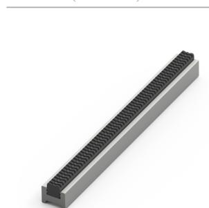
Pour les grandes installations dans le sens de marche, les sections en H doivent être utilisées comme barre d'espacement pour séparer le tapis en tailles gérables. Fourni en sections de 3 m de longueur, avec vis de fixation et chevilles. Livré en noir, avec la couleur de l'insert spécifiée. Taille: 14 mm x 13 mm
